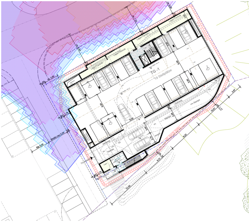
Überlagerung Brückenunterbau mit der Tiefgarage incl. Verbau
